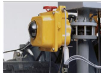
Wirkungsvoll vor der 1. Stufe angeordnet passt er im Regelbereich bei konstantem Enddruck den Volumenstrom exakt dem tatsächlichen Druckluftbedarf an und spart zudem bis zu 9 % Energie im Vergleich zur üblichen Ventilregelung.
