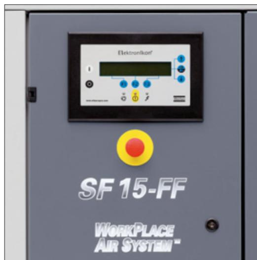
Die speziell entwickelte Software nutzt optimal die zusätzlichen Vorteile, die sich durch das Multicore-Konzept ergeben: sequenzieller Betrieb, stufenlose Volumenstromregelung für niedrigsten Energieverbrauch – dabei verhalten sich die Einzelmodule durch die Softwaresteuerung wie ein einziges SF-Aggregat.
