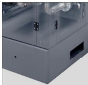
Der Kolbennachverdichter ist auf einem massiven Betonfundament aufgebaut. Dadurch ist es nicht notwendig, den Kolbenverdichter auf dem Boden zu verankern. Durch das Gewicht des Grundrahmens wird ein Großteil der Schwingungen absorbiert.
